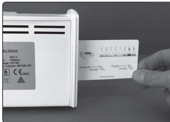
Abbildung 18: Einschieben der „ChipCard“
